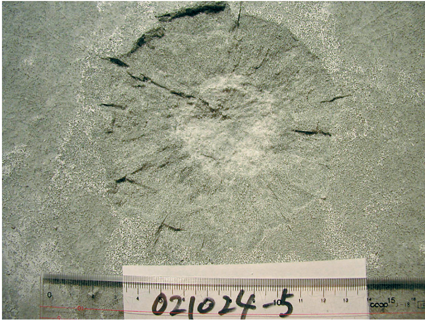
写真 1. 火星凍土模擬試料表面に形成された衝突クレーター。 岩石（蛇紋岩粉末）と氷が混ざった試料に氷が約 650 m/s で衝突して できたクレーター。岩石含有率は 25 重量%である。
