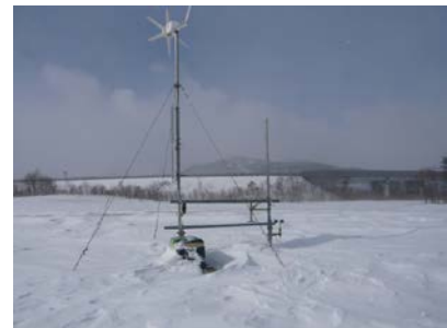
図4 吹雪計（SPN）の設置状況
