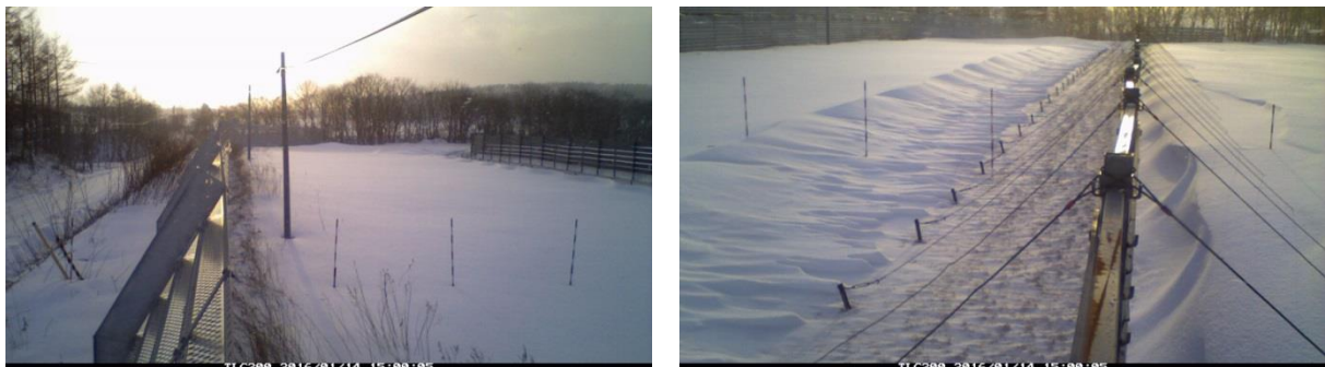
図 6 2016 年 1 月 14 日 16 時の撮影画像 (左：吹き止め柵，右：吹きだめ柵)
